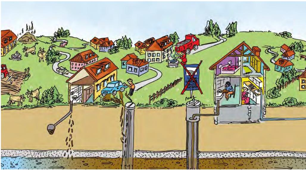
Darstellung möglicher Beeinflussungen auf den Grundwasserkörper
